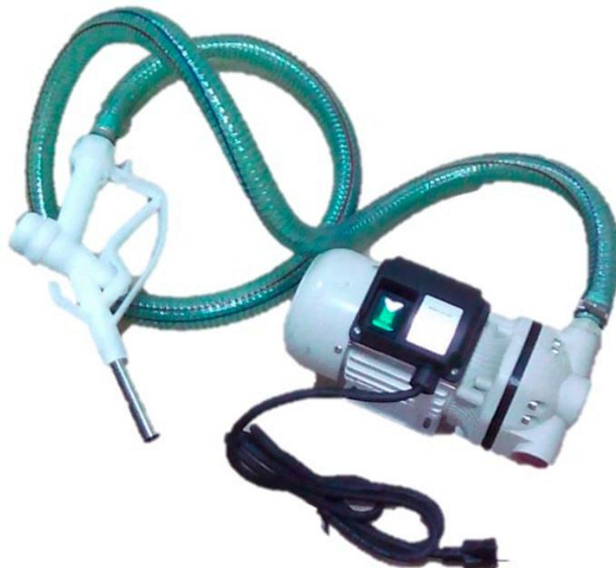
Bomba eléctrica de diafragma 110V, conexión de succión y descarga de 1", Cuerpo de polipropileno y diafragmas de teflón, caudal de descarga 10GPM, Presión de descarga 40psi, Ciclo de trabajo máximo 30 minutos, incluye mangueras y pistola. Especial para trasiego de productos corrosivos, urea, tintas, pinturas, farmacos, solventes, alcoholes, salsas y líquidos de viscosidad media. Marca "ARCO"
