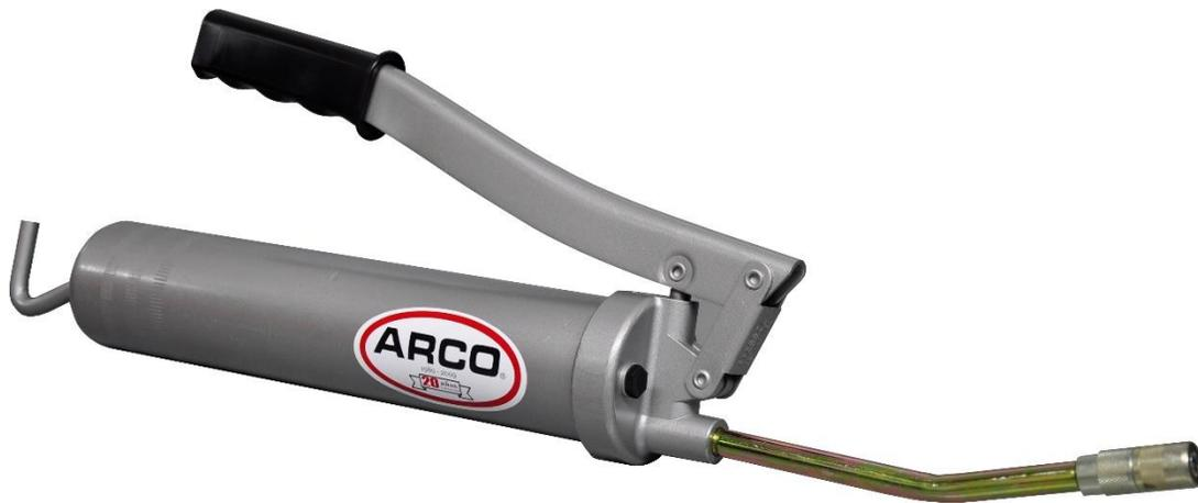
Bomba de engrase robusta construida totalmente en acero, funcionamiento de tipo palanca, longitud porta boquilla 20 cms, potencia de salida 3000 -3500psi., caudal de despacho 5grs. por impulso, se suministra con plato seguidor de grasa y resorte en la parte interna del cilindro. Para trabajo medio. Longitud cilindro: 30cms. Diámetro cilindro: 7cms. Peso aprx. 1kg.
