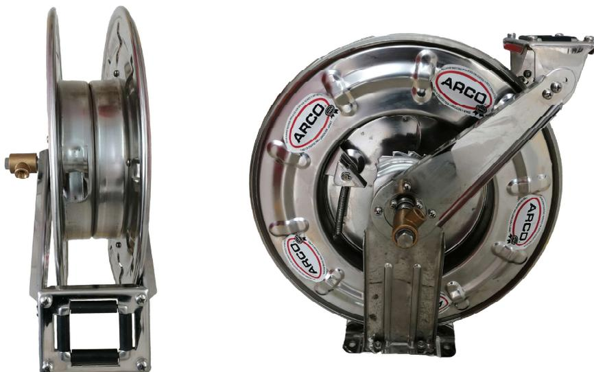
Carrete autorretráctil de acero inoxidable para trabajos pesados que se adapta al piso del techo, 3000 psi sin manguera, entrada y salida de 1/2". Especial para conducción de agua, alimentos, fármacos, químicos, combustibles y fluidos corrosivos. Para trabajo pesado industrial. (No incluye manguera ni adaptación para mangueras diferentes a 1/2") Incluye tope de goma con tornillos. Marca ARCO.
