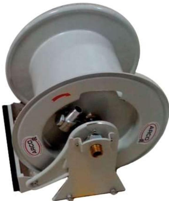
Carrete de metal autorretráctil de alta resistencia, apto para techo-piso, sin manguera para 3000psi, con entrada y salida de 1". Especial para todo tipo de combustibles, aceites, aire o grasas, no apto para productos corrosivos. Para trabajo pesado industrial. (No incluye manguera ni adaptación para mangueras diferentes a 1") Incluye tope de goma con tornillos. Marca ARCO.
